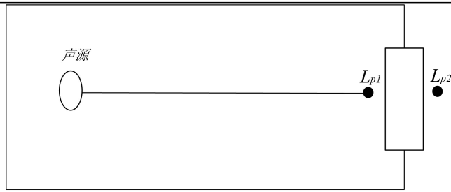
图 4-4 室内声源等效为室外声源图例
