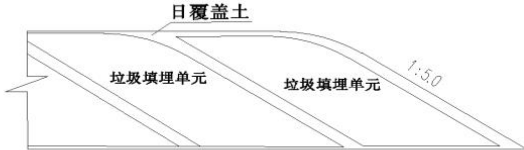
图 2.6-2 生活垃圾单元填埋法示意图
