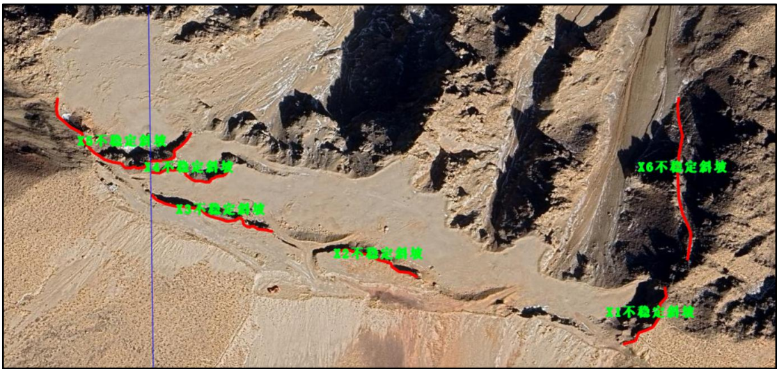
图 3-1 矿区不稳定斜坡分布影像图
